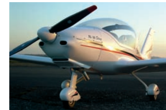
Die schlanke Cowling mit ausgeklügelter Motorlüftung ist elegant und zweckmäßig zugleich.
