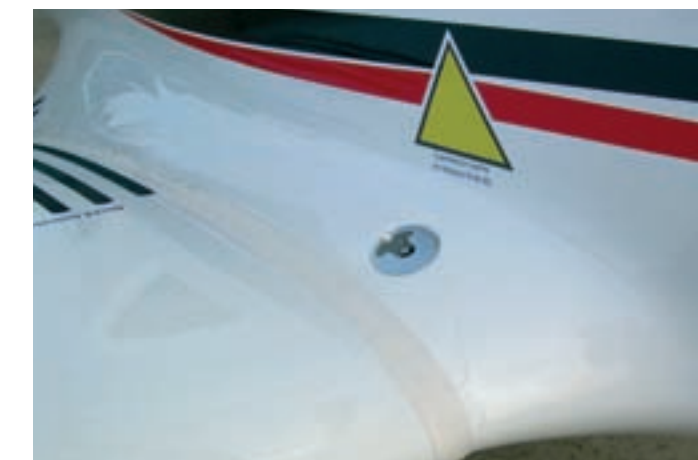
An der Flügelwurzel rumpfseitig fügt sich der abschließbare Tankdeckel sauber in die Oberfläche ein.
