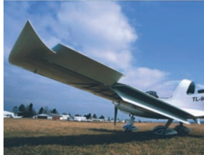
Ausgefeilte Aerodynamik: Kleine, tiefe Querruder garantieren eine schöne Ruderabstimmung im Langsam- wie im Schnellflug. Große Spreizklappen bringen den TL 96 Sting auf jedes Flugfeld.
