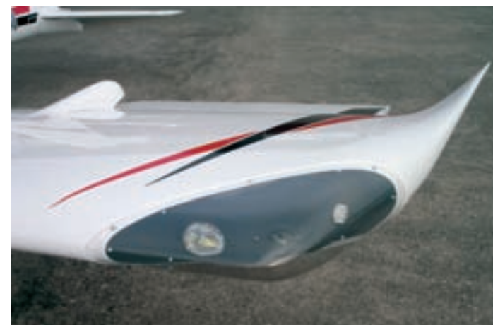
Aerodynamisch im Randbogen integriert ist die Halterung für Beleuchtung und Positionslichter.
