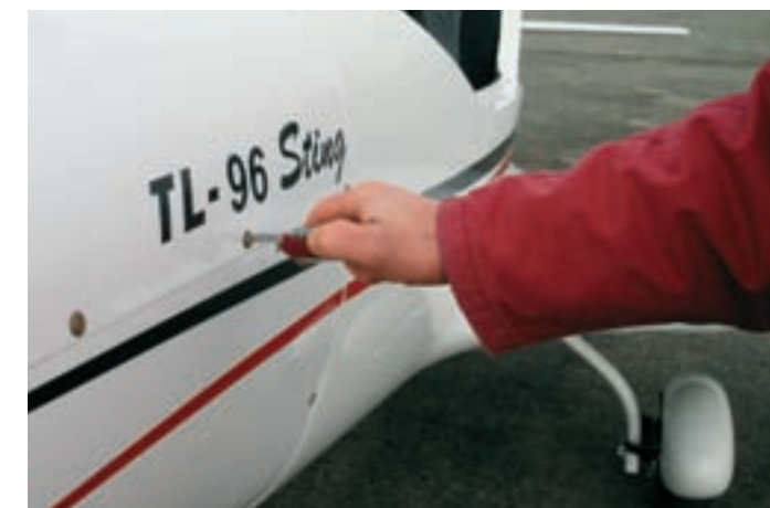
Quick-Locks an der Motorcowling lassen sich auch mit einfachem Werkzeug schnell öffnen und schließen.
