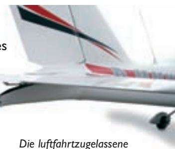
Die luftfahrtzugelassene Tost-Schleppkupplung ist beim TL 96 Sting schön in einen stabilen CFK-Träger integriert.
